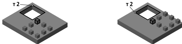
Рис. 90.5. Зависимость между расположением копий и положением точки начала копирования (траектория копирования и исходный элемент выделены)
