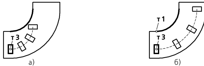
Рис. 90.4. Схема копирования элемента выдавливания вдоль всей направляющей с сохранением ориентации (направляющая и исходный элемент выделены): а) положение базовой точки определяется автоматически, б) в качестве базовой точки выбрана точка 1
