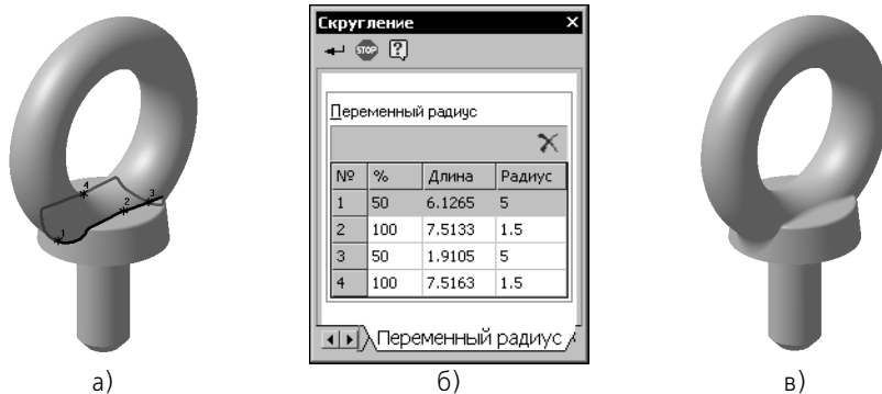
Рис. 88.4. Построение скругления с переменным радиусом: а) указание точек, б) задание параметров скругления, в) результат выполнения команды
