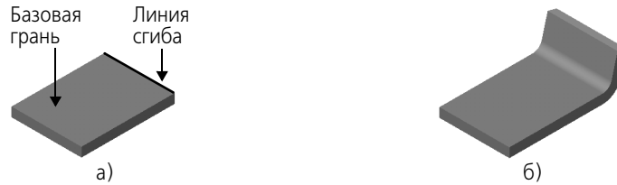
Рис. 94.9. Сгиб вдоль ребра: а) базовая грань и линия сгиба, б) результат построения
