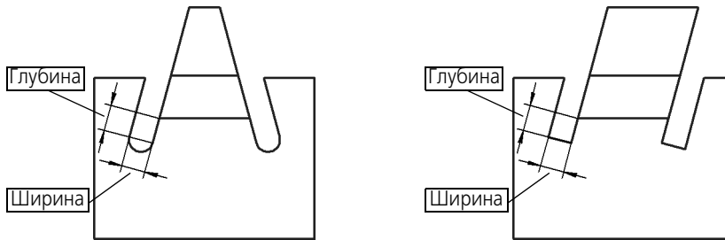
Рис. 94.19. Определение размеров освобождения сгиба при отличном от нуля угле на сгибе
