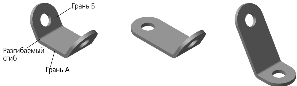
Рис. 97.1. Зависимость результата разгибания от выбора неподвижной грани: а) исходное состояние детали, б) неподвижна грань А, в) неподвижна грань Б
