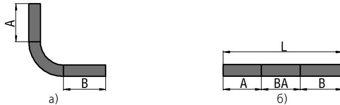
Рис. 92.11. Разгибание сгиба: а) сгиб согнут, б) сгиб разогнут
