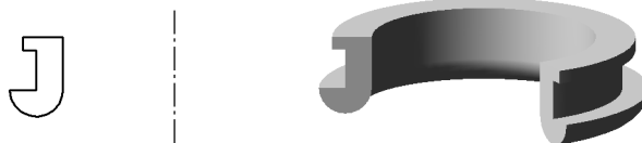
Рис. 80.4. Эскиз и элемент, образованный операцией вращения
